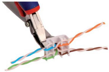
Seguite il codice colore per posizionare i cavi nei morsetti. Mantenete le coppie arrotolate il più possibile e tagliate i cavi in eccesso.
